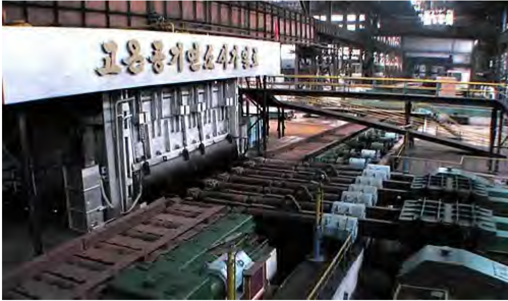
[그림 IV-1-3] 김책제철연합기업소의 열간압연공장(고온공기연소식가열로)
